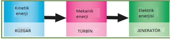
Şekil 1. Enerji dönüşümü rüzgar türbininde meydana gelir
