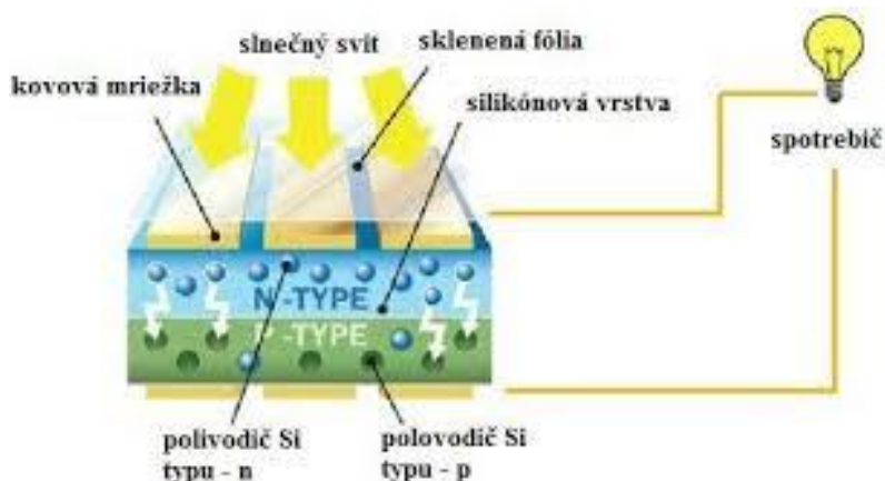
Obr. 13. Princíp činnosti fotovoltaického článku https://core.ac.uk/download/pdf/44402822.pdf
